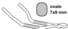
Fig. D: rails ovales en carbone. Taille de bride de 7 x 9 mm.
